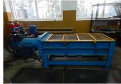
Rys. 8. Urządzenie do prób wytrzymałościowych urządzeń ciągnących
