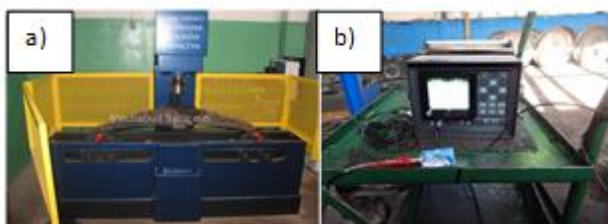
Rys. 11. a) Prasa do badania charakterystyki resorów piórowych [8] b) Urządzenie do badań ultradźwiękowych
