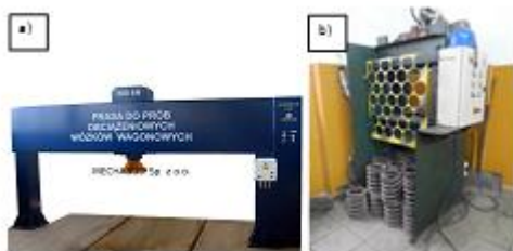
Rys. 10. a) Prasa do badania charakterystyki wózka wagonu [7] b) Prasa do sprawdzenia charakterystyki sprężyn śrubowych
