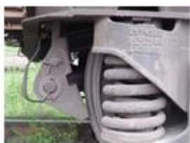
Rys. 3. Brak klocka hamulcowego w węglarce budowy normalnej typu 401 Wb
