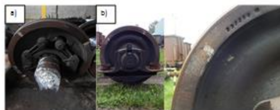
Rys. 5. a) Koło obręczowe nowe z węglarki budowy normalnej typu 401 Wb, b) Koło obręczowe z przesunięciem obręczy z węglarki budowy normalnej typu 401 Wb
