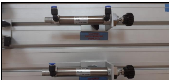
Rys. 2. Siłownik jednostronnego działania i siłownik dwustronnego działania SMC (opracowanie własne)
